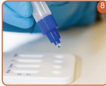
Placer la cassette sur une surface complètement plane. Déposer 3 gouttes de réactif dans chaque puits. Attendre 10 minutes. Le liquide migre progressivement le long des bandelettes.
